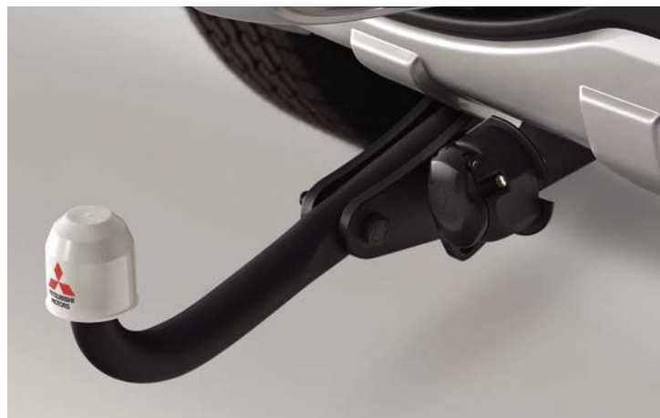
Прицепное устройство фиксированное Горизонт. нагрузка 3300 кг. Вертик. нагрузка 135 кг. MZ313838 Комплект электропроводки MZ313883 (розетка 7 контактов)
