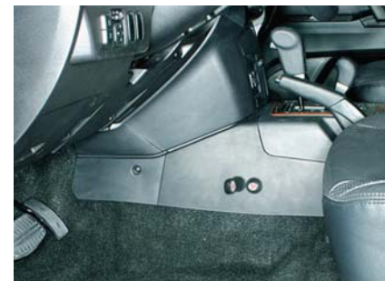
Замок АКПП, типтроник штырьевой RSA-MIT-665
