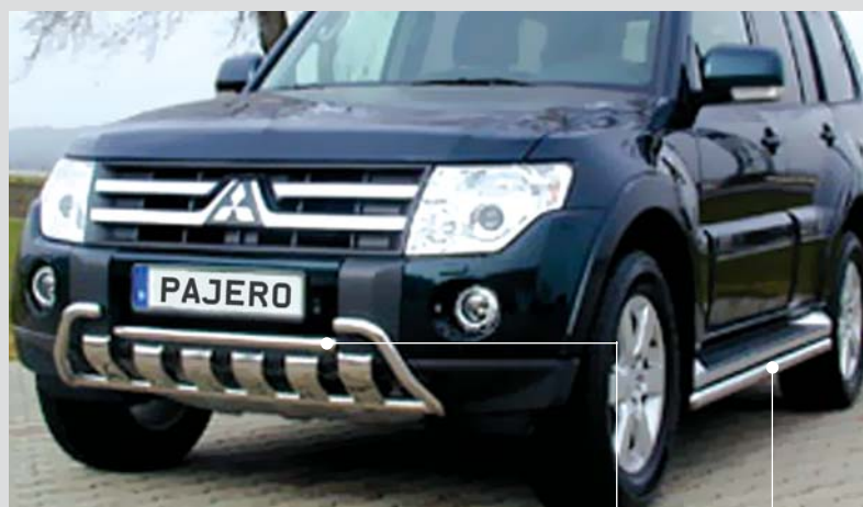
Защита воздухозаборника, Seko Труба 40 мм. Полированная нержавеющая сталь 660150 Защита порогов (5-doors), Seko Труба 40 мм. Полированная нержавеющая сталь 660520
