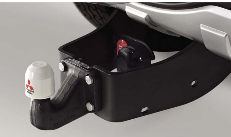
Прицепное устройство фланцевое Горизонт. нагрузка 3300 кг. Вертик. нагрузка 135 кг. MZ313839 (для а/м без накладки заднего бампера) Комплект электропроводки MZ313883 (розетка 7 контактов)
