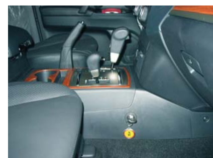
Замок АКПП, типтроник бесштырьевой, нажимного типа RSA-MIT-1109R
